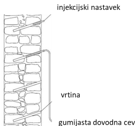
Slika 9: Izvedba vrtin in namestitvev injekcijskih nastavkov v zidu
